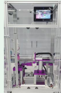
5 • 라미네이트가 부착된 웨이퍼를 PTP를 이용하여 이송
