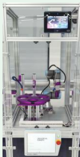
6 • 웨이퍼와 라미네이트 부착 공정 및 분리 공정에 협동 로봇 적용
