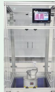
8 • 웨이퍼 출하 및 적재를 위한 진공 트랜스퍼 로봇 적용
