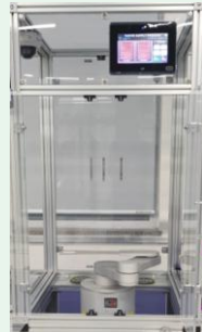
3 • 웨이퍼 공급 및 적재를 위한 진공 트랜스퍼 로봇 적용
