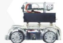
알티노 라즈베리 파이형은 카메라를 이용한 영상처리를 화상 피를 인식하고 방향을 판단하거나 색을 구별하여 주행 상태를 판단하는 등의 자율 주행을 수행할 수 있습니다.
